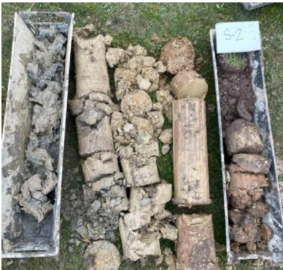
Obrázek 3: Fotodokumentace sondy S-2 (sonda má opačné kladení spodních vrstev zprava doleva)
